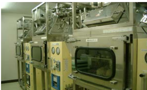
工業用ナノ材料の吸入曝露試験システム
