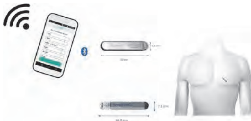
図2 植込み型心電計と遠隔モニタリング機能 中央上：Jot Dx (Abbott 社製), 中央下：Reveal LINQ (Medtronic社製)
